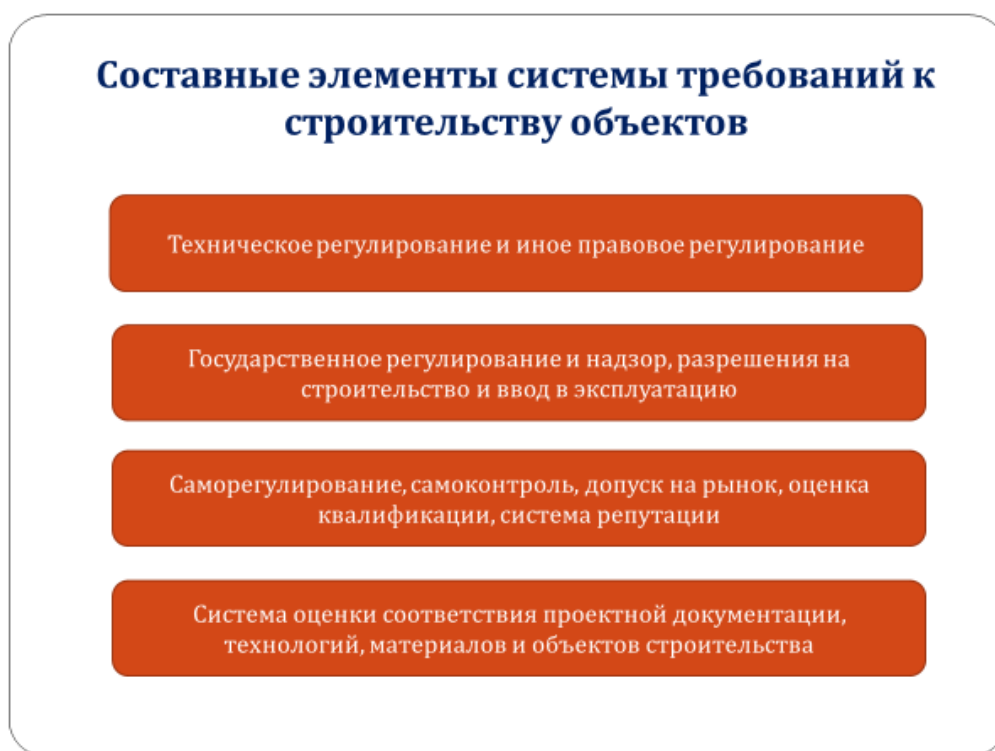
Рисунок 3.1 – Структура системы требований к капитальному строительству
